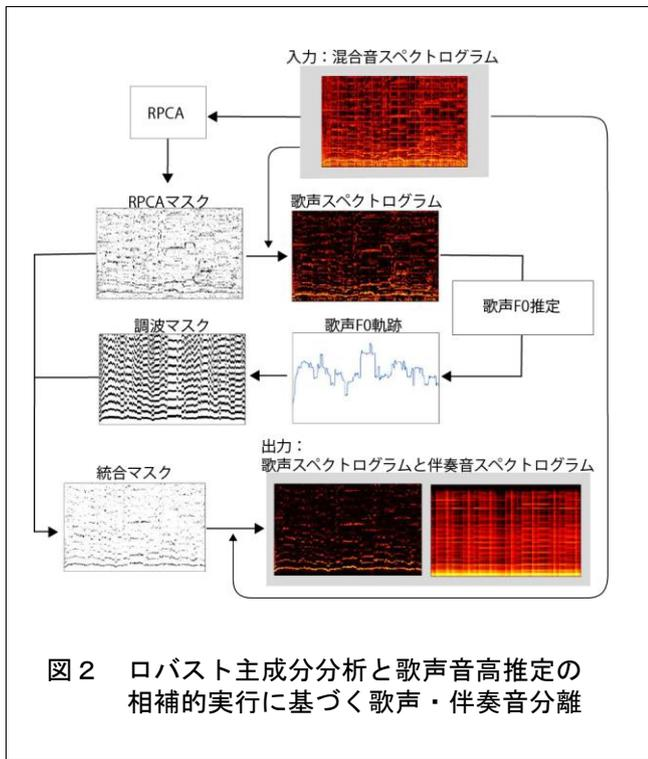
図2 ロバスト主成分分析と歌声音高推定の相補的実行に基づく歌声・伴奏音分離
