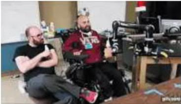
頭頂葉に埋め込んだ電極で運動意図を読み取り、ロボットアームを操作して飲み物が飲めるように
