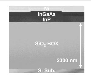
図3 ウェハボンディングで作製した導波路型 InGaAs 受光器用 III-V-0I 基板の断面 TEM 像
