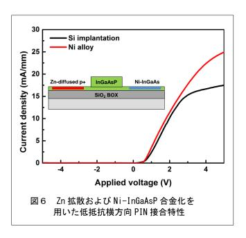
Zn 拡散および Ni-InGaAsP 合金化を用いて、キャリア注入型光可変減衰器 (variable optical attenuator) の作製を試みた[10]。横方向 PIN 接合を通じて電子およびホールを導波路に注入すると、自由キャリアにおり光損失が生じるので、光減衰量を自在に制御可能となる。作製した素子の上部顕微鏡写真を図 7a に示す。電流注入時の波長 1550 nm における光減衰量の測定結果が図 7b となる。接合の低抵抗化により、大きな電流が注入可能となったことから、ホールの価電子帯吸収を用いた動作が実現した。その結果、40 mA/mmの電流中時に45 dB/mmという大きな光可変減衰量を得ることに成功した。
