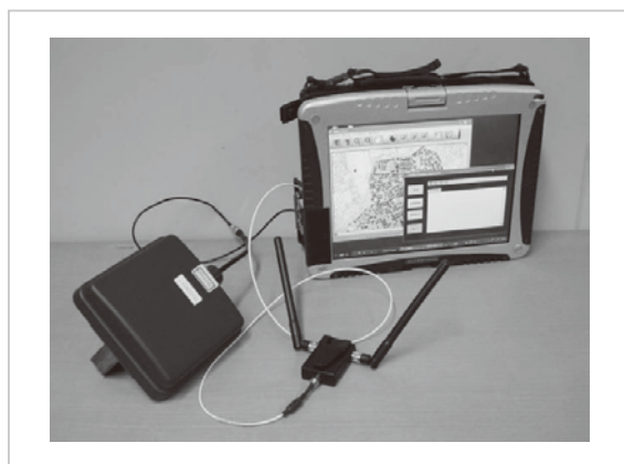
図 2 ハイブリッド RFID リーダ・ライタ (平面アンテナがパッシブ RFID 用、ダイバシチアンテナがアクティブ RFID 用)
