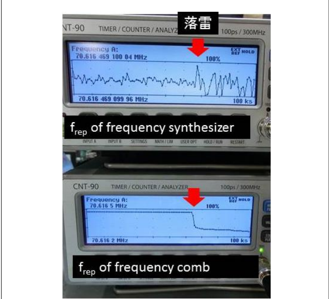
図5 落雷による繰返し周波数のロック外れ
