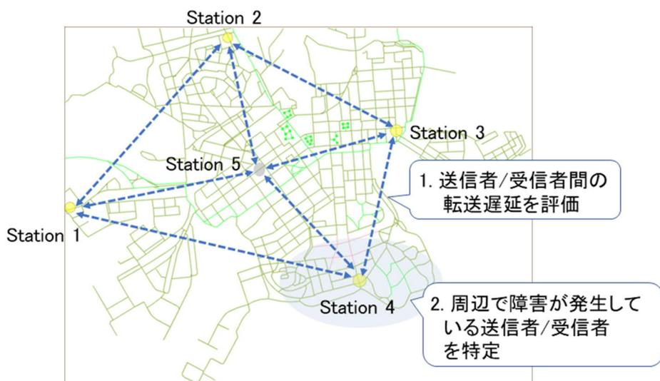
図3 転送遅延の解析による障害発生箇所の検知
