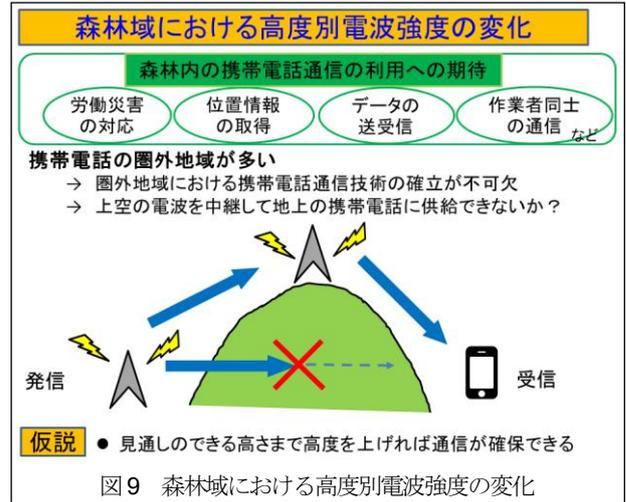
図9 森林域における高度別電波強度の変化
