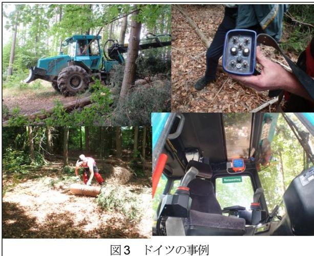
ドイツの事例(図3)をご紹介します。左上の写真は木を集めてくる作業車です。左下に写っているオペレーターが基本的に1人で作業をしています。もしこのときに事故があったらどうするかという仕組みが、オペレーターが装着する右上の写真の機械と作業車のキャビンの中に入っています。これらの機械が30分動かないと、あるところに緊急通報が行き、そこからオペレーターの携帯電話に電話が入るようになっています。
