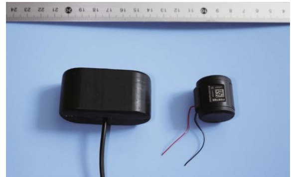
図 1 試作した牽引力錯覚の提示装置
