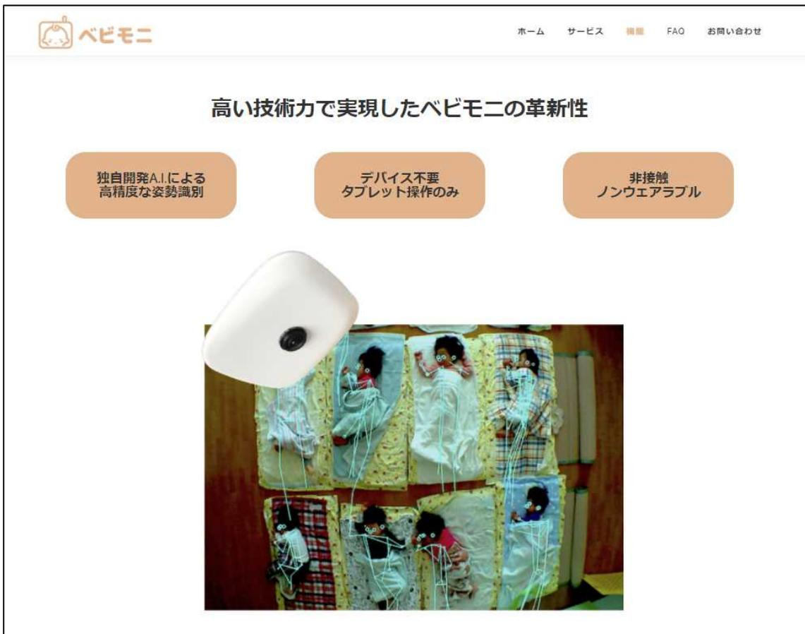
カメラによって乳幼児の危険な姿勢を検知する午睡チェックシステムである。保育園の室内に天井カメラを設置することで、一台あたり複数人の乳幼児の姿勢を検知し、うつ伏せ時にはアラートを出しながらブレスチェック記録を残すシステムである。5分ごとに必要な保育者による午睡チェック作業をサポートし、業務負担と精神的負担の軽減を目的としている。
